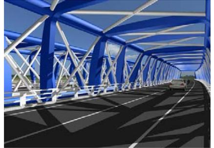
*Celosía metálica especial propuesta para solucionar el cruce entre una línea de ferrocarril de alta velocidad y una autovía en la entrada de León*
